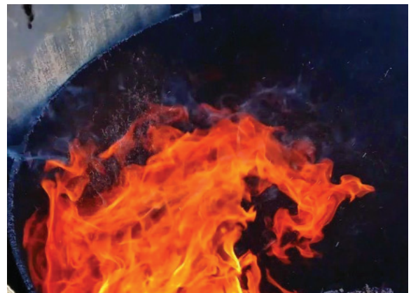
Las puntas de las llamas se enroscan hacia abajo en un horno tapa de llama, lo que muestra cómo todo el aire proviene de arriba en un flujo a contracorriente. Foto por Kelpie Wilson.
