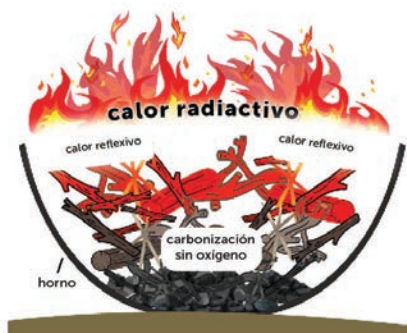
Cómo un horno tapa de llama produce biocarbón. Concepto de imagen de Kelpie Wilson, diseñado por Jessica Brothers.
