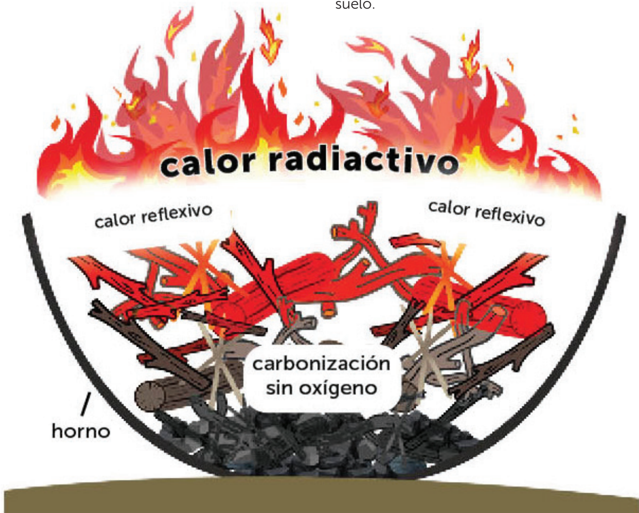
Como un horno con tapa de llama produce biocarbón. Concepto de imagen por Kelpie Wilson, diseñado por Jessica Brothers.
